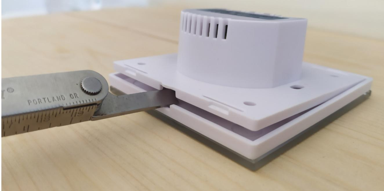
**La plaque est détachée, vous pouvez la remplacer par la nouvelle**
