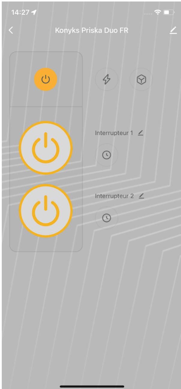
Les boutons Interrupteur 1 et Interrupteur 2 permettent d'allumer ou éteindre à distance chacune des prises. L'interrupteur juste au-dessus permet de contrôler les 2 prises simultanément.
