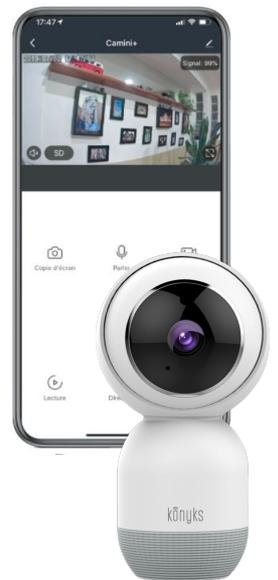
Requiere una red Wifi 2.4 Ghz • Vídeo Full HD 1920x1080 • Detección de movimiento Hasta 10 m con seguimiento de la persona detectada • Ángulo de visión 80° • Grabación en tarjeta Micro SD hasta 64 GB • Rotación motorizada 355°en horizontal y 110 °en vertical con control remoto desde el smartphone • Audio bidireccional, Micrófono y Altavoz integrados • Visión nocturna por LED IR hasta 10m • Alimentación 5V DC 2A • Peso 170g • EAN 3770008652309
